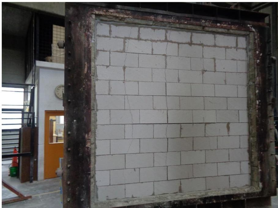
Imagen 11 - Aspecto de la cara expuesta de la muestra una vez finalizado el ensayo.
